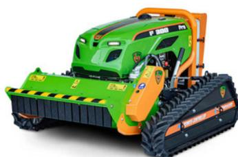
La débroussailleuse de pente F300 PRO est le classique Green Climber, équipée d'un moteur Diesel de 24 CV et d'un agrégat fixe entre les trains de chenilles. Sa grande maniabilité et son centre de gravité bas garantissent une stabilité exceptionnelle sur des pentes allant jusqu'à 60°.
